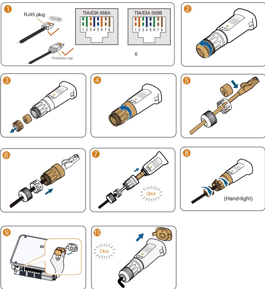
COM2 ( DI , DRM , DO , RS485 , Meter ) / COM2 ( DI , MRD , DO , RS485 , medidor ) / ( داده RS485 ، DI ، DRM ، DO )
