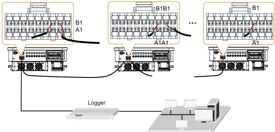
COM2 Connection (DRM) / Conexión COM2 (MRD) / COM2 (DRM) / توصیل COM2 ( DRM ) / Połączenie COM2 (DRM) / Branchement COM2 (DRM) / Conexión de COM2 (DRM) / Collegamento COM2 (DRM) / Conexiune COM2 (DRM) / Conexão COM2 (DRM) / COM2-aansluiting (DRM) / COM2-liitäntä (DRM) / COM2-anslutning (DRM) / COM2 csatlakoztatás (DRM) / Ligação COM2 (DRM)
